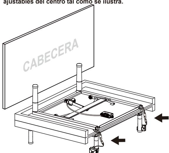
PASO 2: Conecte los conectores del sensor de movimiento tal como se ilustra. Tenga en cuenta que hay dos conectores, uno a cada lado de la cama.
